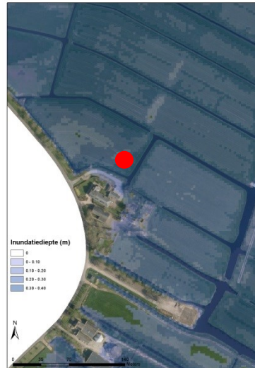
B: Waterdieptel na 23 uur inlaat. Bij de rode stip is het waterpeil NAP -2,08 m.
