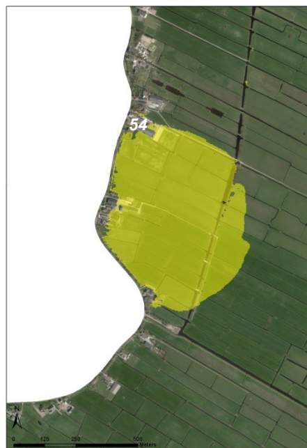
Figuur 6 A: waterhoogte van de inlaatgolf op 23 uur na de start van de inlaat. B: reikwijdte van de inlaatgof.
