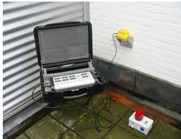
Figuur 3 Voorbeeld trillingsmeetapparatuur
