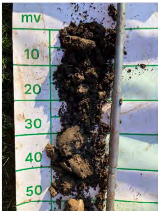
Afbeelding 8. Resultaat van de profielboring.
