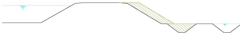
Figuur 5.2 Taludverzwaring met mogelijke demping en sloot vergraven
