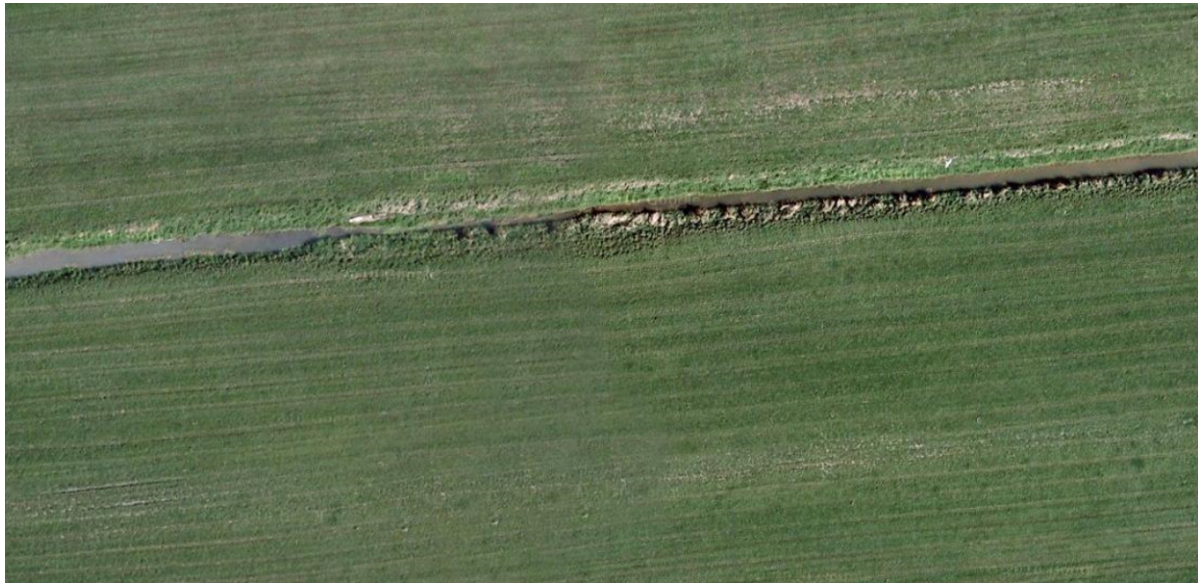
Figuur B4.30 Bovenaanzicht van de hoofdwatergang die problemen in de afwatering veroorzaakt als gevolg van ingestorte oevers.
