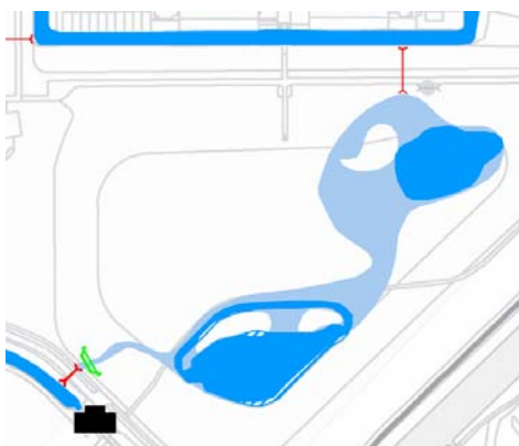
Figuur 5.5 Gerealiseerde herinrichting Park de Kuil door het Stadsdeel. Bestaande waterpartijen (donkerblauw) zijn uitgebreid en met open water met elkaar verbonden. Aan de noordzijde kan water ingelaten worden vanuit de woonwijk. Overtollig water kan met een nieuwe stuw en duiker aan de zuidzijde worden afgevoerd.
